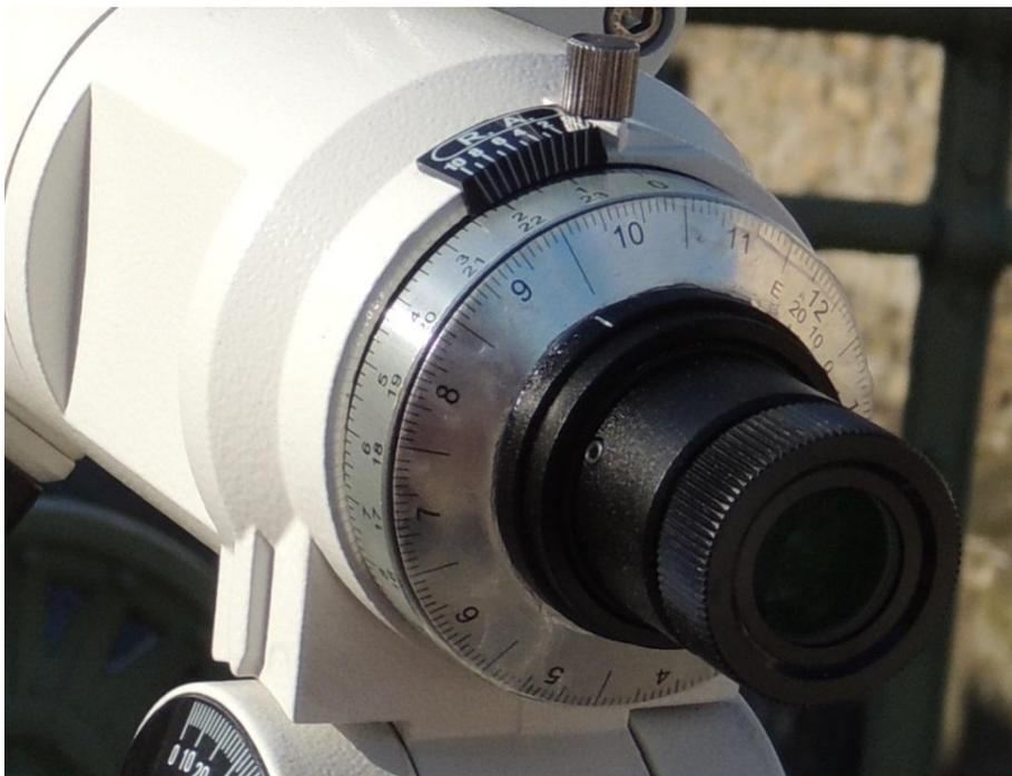
Abb.2. die Datum- und Uhrscheiben am Polarscope
