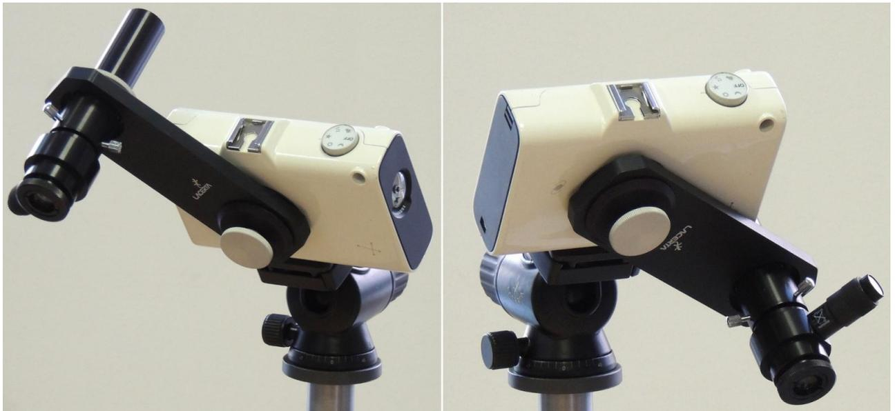
Abb. 9.: Polarscope Off Axis montiert.
