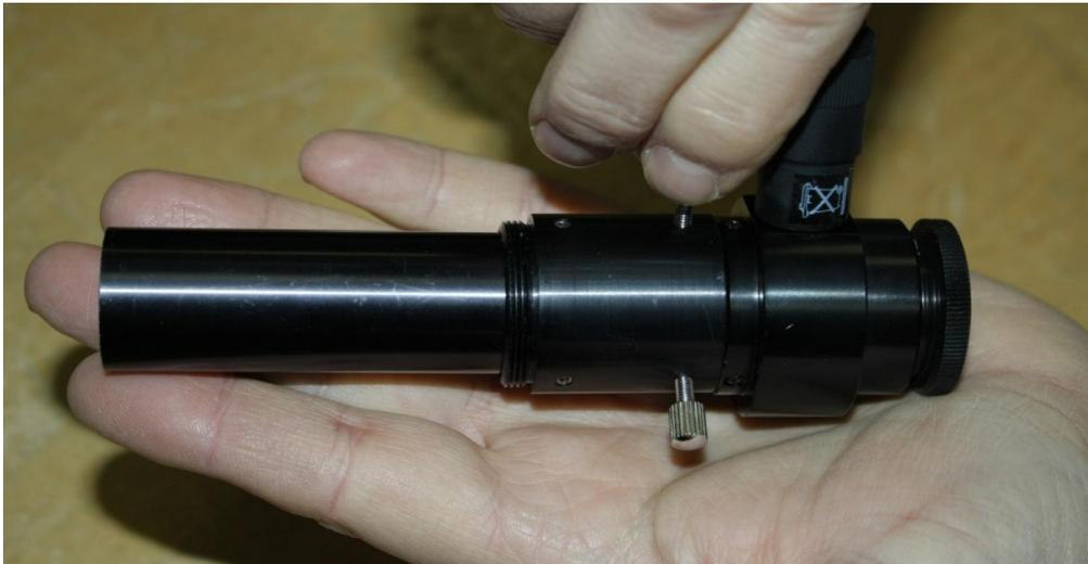
Abb.4.: Die Justierschrauben beim Polarscope „ polarF52“ kippen das Rohr
