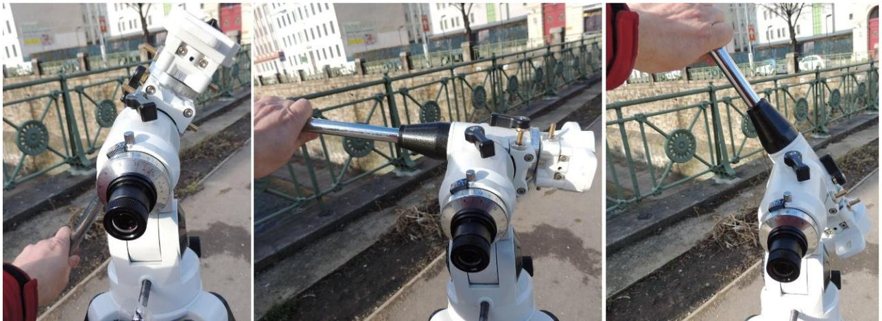
Abb.6.: Strichplatte und RA-Achse drehen sich miteinander
