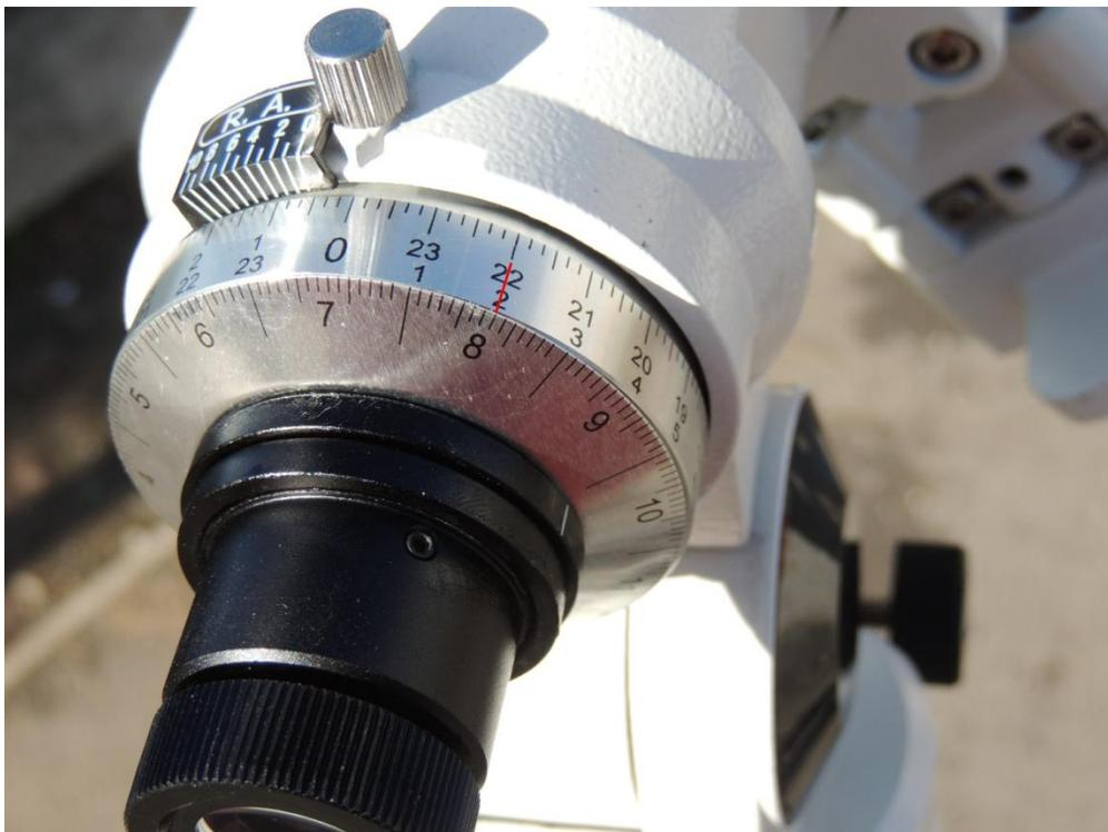
Abb.13.: Polarscope fertig eingestellt auf 16. August, um 22:00 Uhr (23:00 Sommerzeit)
