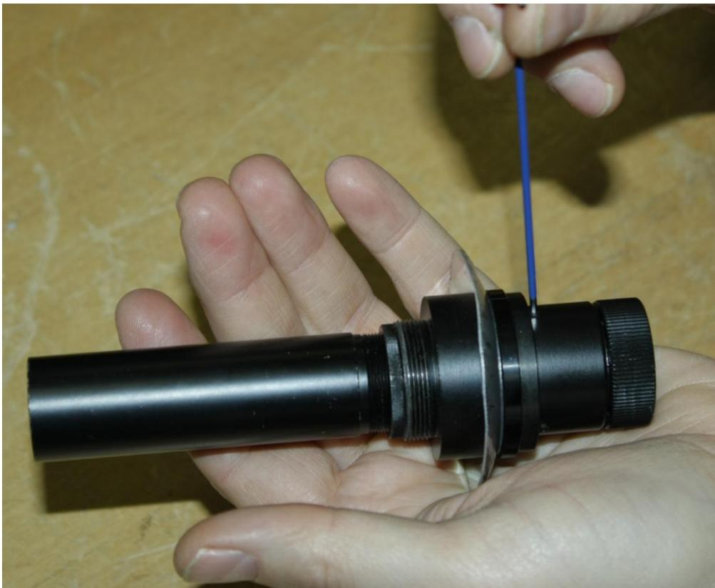
Abb. 5.: Die Justierschrauben beim HM6 Polarscope verschieben die Strichplatte
