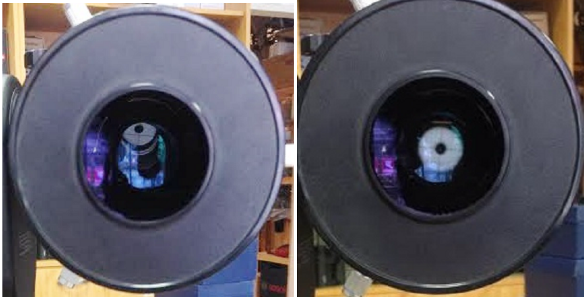
Die beiden Abbildungen zeigen das Herschelprisma im dejustierten (links) und dann im justierten (rechts) Zustand.
